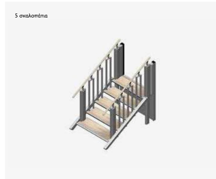
5 σκαλοπάτια Διαδρομή ανύψωσης: 600 – 1110 mm, Μήκος πλατφόρμας: 1525 mm
